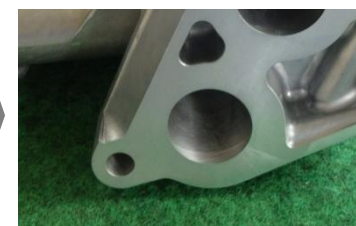
インサート部を全て削り出し、 本体側の加工代をできるだけ少なく し内径部の巣の低減を図る
