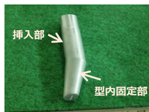
インサート用アルミ部品 鋳造および切削等で製作する
