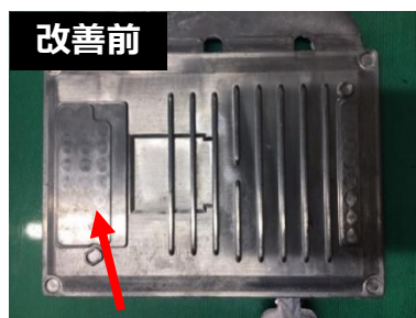
削り代を設けて铸造 湯回り不足を解消
